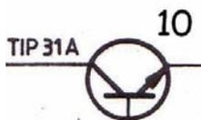
Transistor. Dispone de tres terminales: emisor (indicado por la flecha), base y colector. La corriente de la base controla la corriente de salida.
